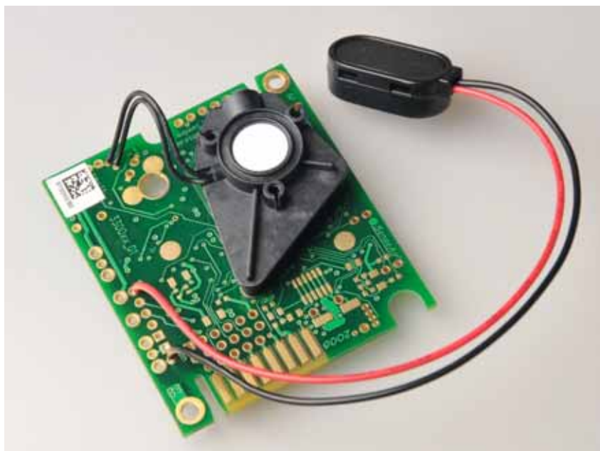
Figure 2: CO 2 Engine ® BLG のVbat+を介した電源供給
