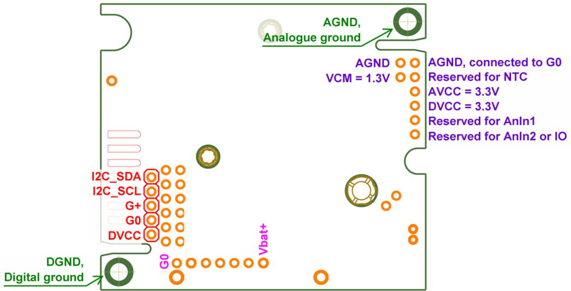
Figure 2: CO<sub>2</sub> Engine® ELG のI/O表記および端子位置
