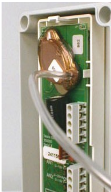
写真1: サンプルテストガス入力ポートに接続されたテストガスチューブ
